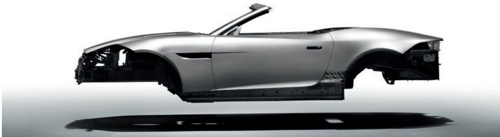
过去十多年来，捷豹始终处于全铝车身结构的最前沿，而且还将继续推动该技术的发展。具有高扭转刚度的轻质铝车身结构是理想的跑车平台，对 F-TYPE 的性能、操控和驾驶感受至关重要。结实、坚固的车身结构可提供与生俱来的稳固平台，实现精准敏捷的操控，同时微调悬架系统，得到完美的连接性和驾驶反馈。F-TYPE 的车身与高性能发动机相得益彰。它们可以产生卓越的力重比和扭矩重量比，为跑车带来实实在在的性能提升。
